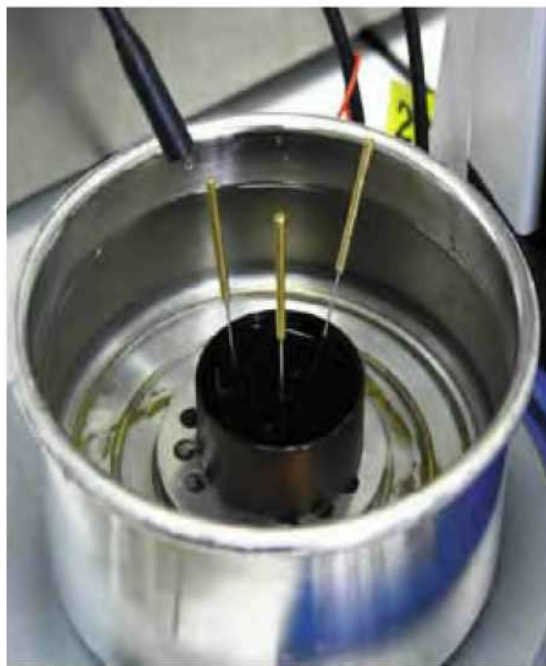
Рис. 1.4. Вид образца битума после проведения испытания
