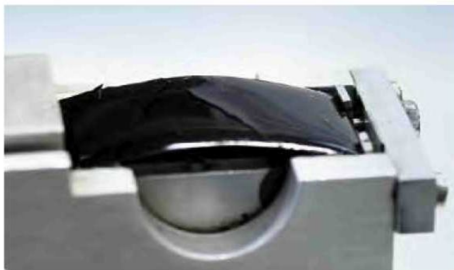
Рис. 1.12. Образцы битума на пластине, размещенные в полуавтоматическом аппарате, до и после проведения испытания – видна трещина в слое битума
