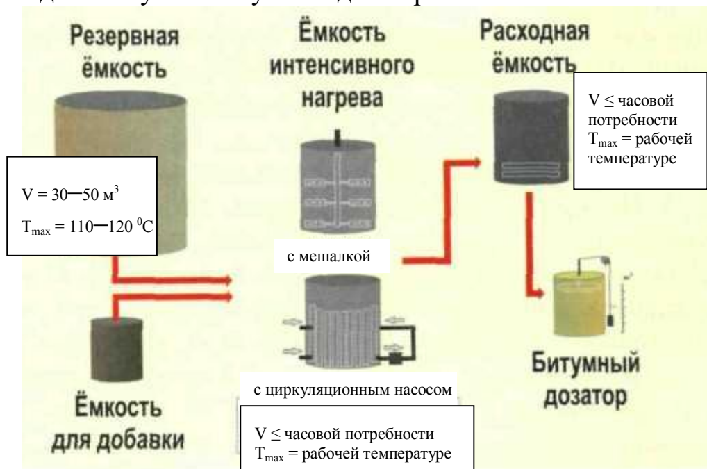
Рис. 5.10. Схема ресурсосберегающей технологии подготовки битума
