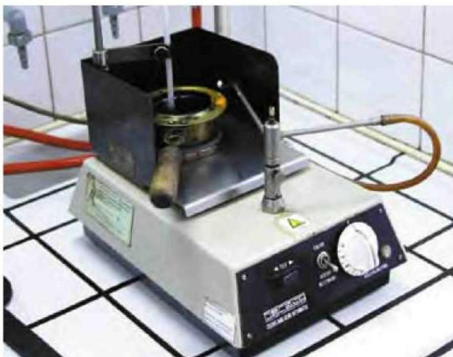
Рис. 1.13. Общий вид аппарата для испытания на температуру вспышки по методу открытого тигля Кливленда
