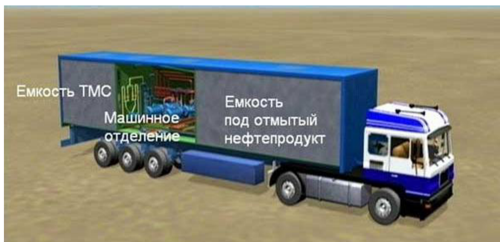
Рис. 6.1. Мобильный комплекс очистки резервуаров
