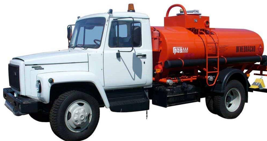
Рис. 3.2. Автоцистерна для перевозки нефтепродуктов на базе ГАЗ 3309
