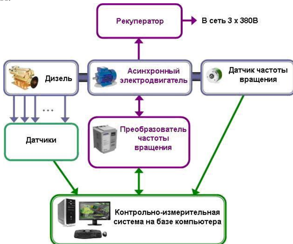
Рис. 4.4. Схема работы стенда для оценки эффективной мощности двигателя
