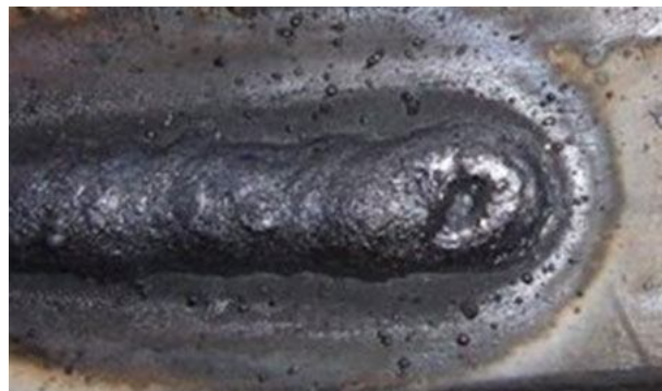
Рис. 8.10. Кратер сварочного шва
