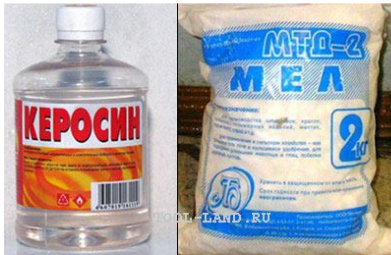
Рис. 8.20. Керосин и мел для проверки качества сварных соединений
