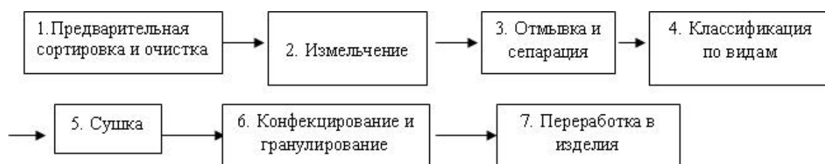
Рис. 10.3. Схема переработки отходов пластмасс
