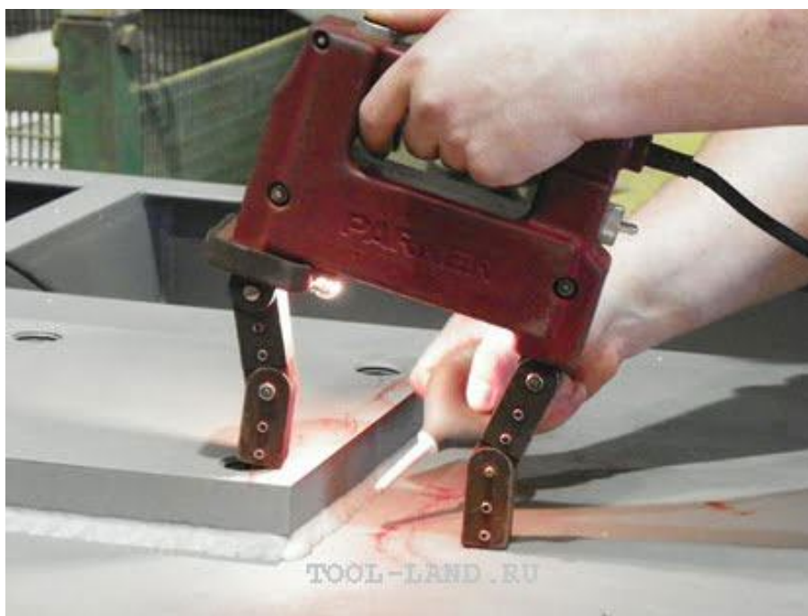
Рис. 8.23. Проверка качества сварных швов магнитной дефектоскопией
