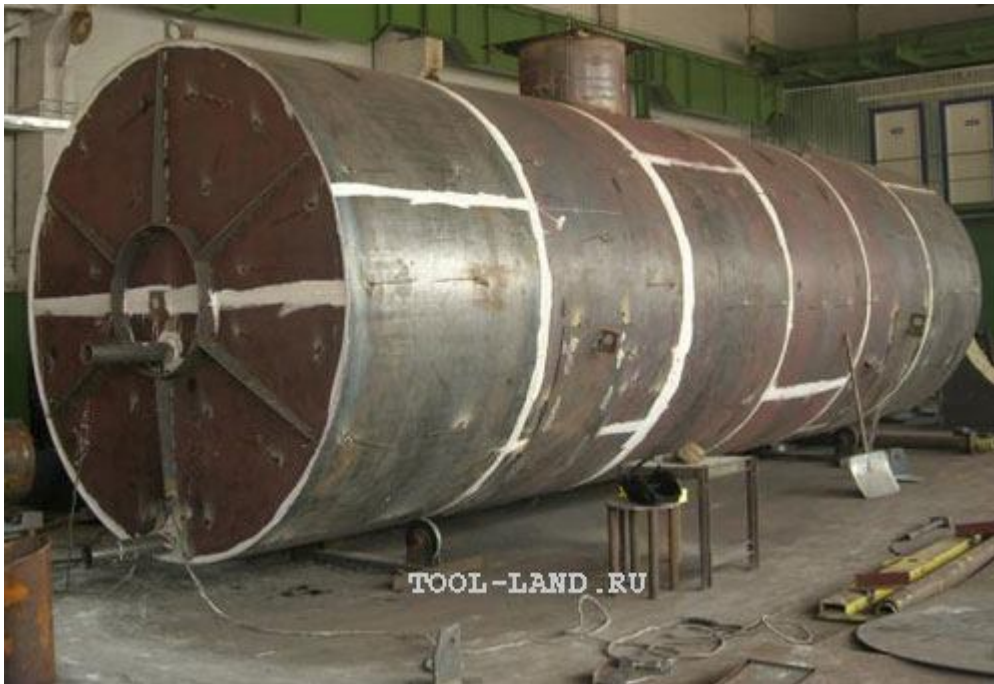
Рис. 8.19. Цистерна, подготовленная для проверки на герметичность с использованием керосина
