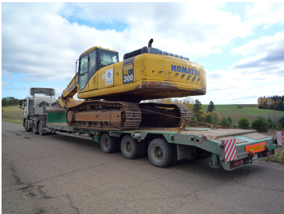
Рис. 1.1. Транспортировка техники автомобильным тралом
