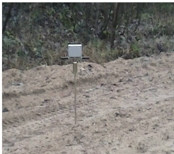
Рис. 7. Определение прочности покрытия пенетрометром ПГ-3М
