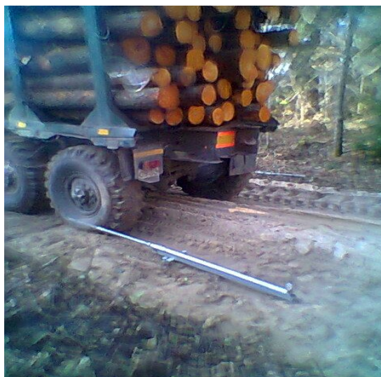
Рис. 8. Испытание дорожной одежды рычажным прогибомером
