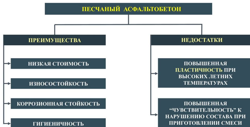
Рис. 1. Преимущества и недостатки песчаных асфальтобетонов по сравнению со щебенистыми асфальтобетонами
