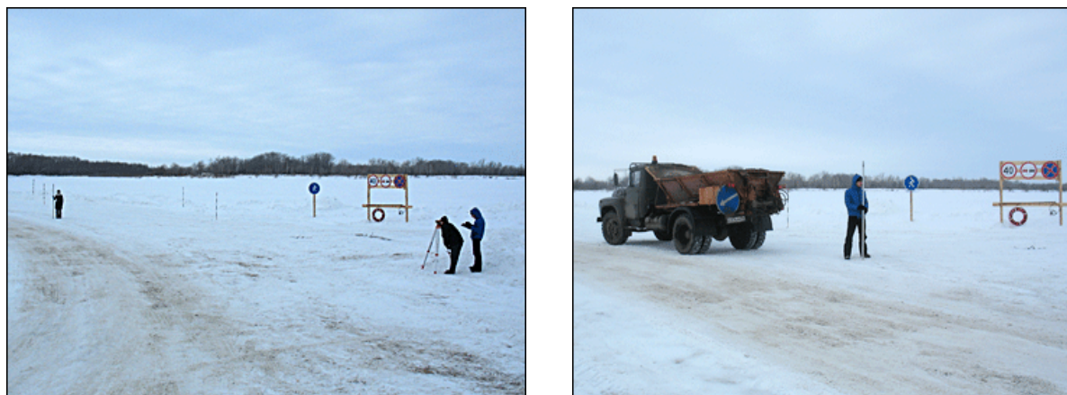
Рис. 10. Испытания – измерение прогибов ледяной плиты под нагрузкой и сравнение показателей на армированном и неармированных участках
