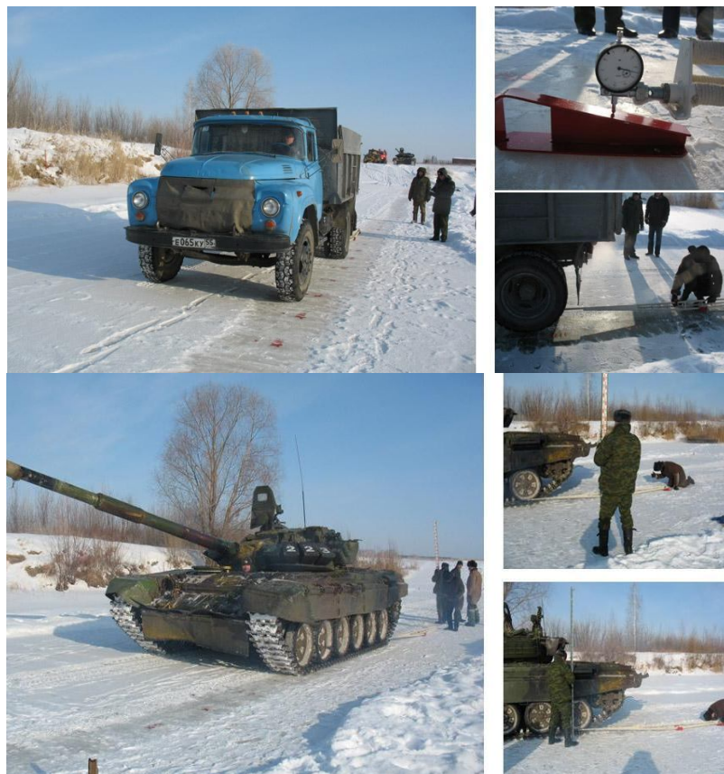
Рис. 6. Испытание опытного участка колёсной и гусеничной техникой
