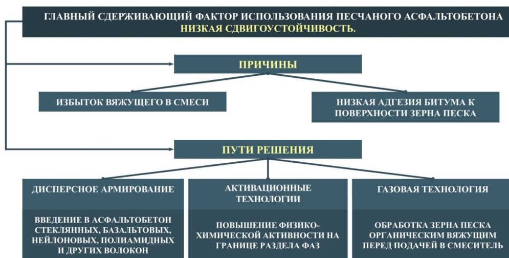
Рис. 2. Причины низкой сдвигоустойчивости песчаного асфальтобетона и пути решения проблемы
