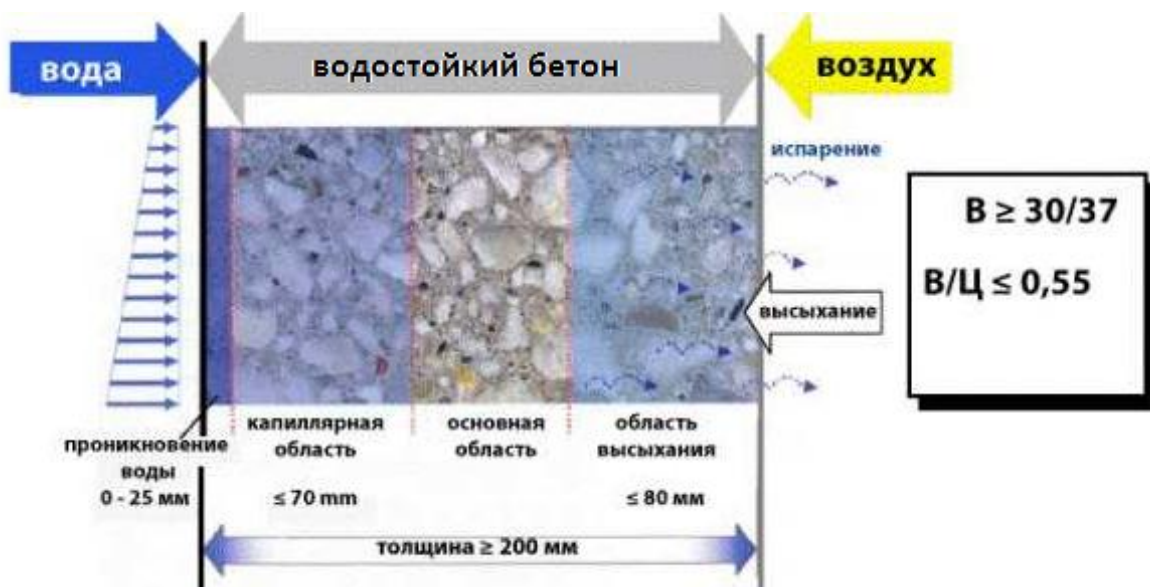
Рис. 2. Водостойкий бетон под воздействием воды и низкой температуры
