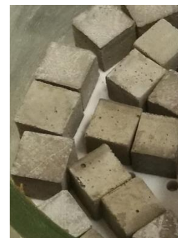
Рис. 4. Образцы для определения прочности при сжатии
