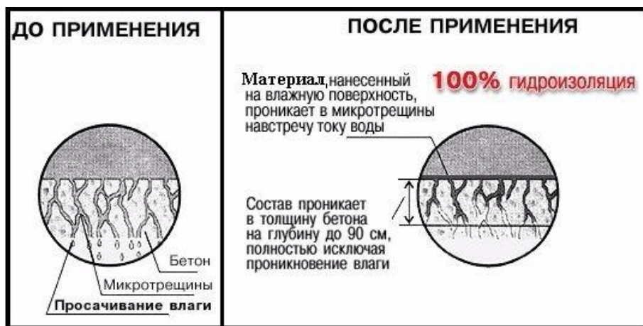
Рис. 3. Принцип действия добавок на бетон
