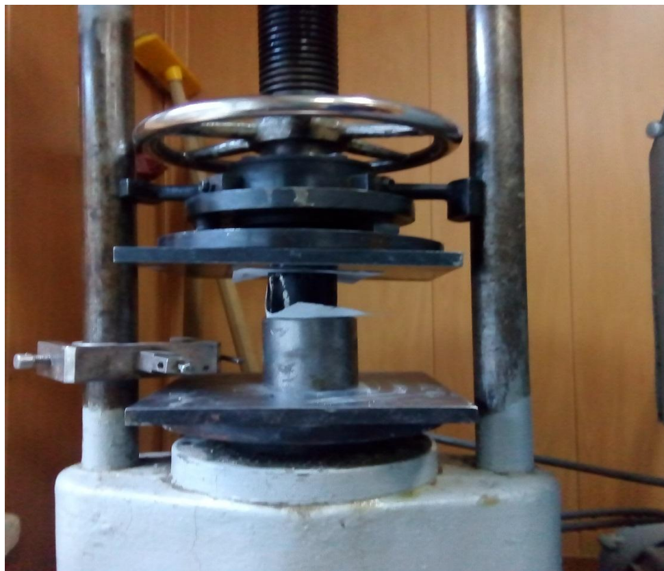
Рис. 2. Испытание асфальтобетонного образца на прочность при сжатии
