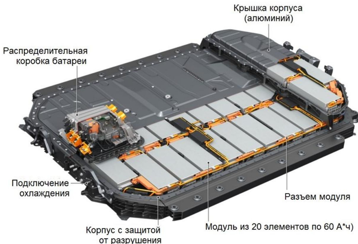
Рисунок 5 – Конструкция аккумуляторной батареи электромобиля на литий-ионных элементах
