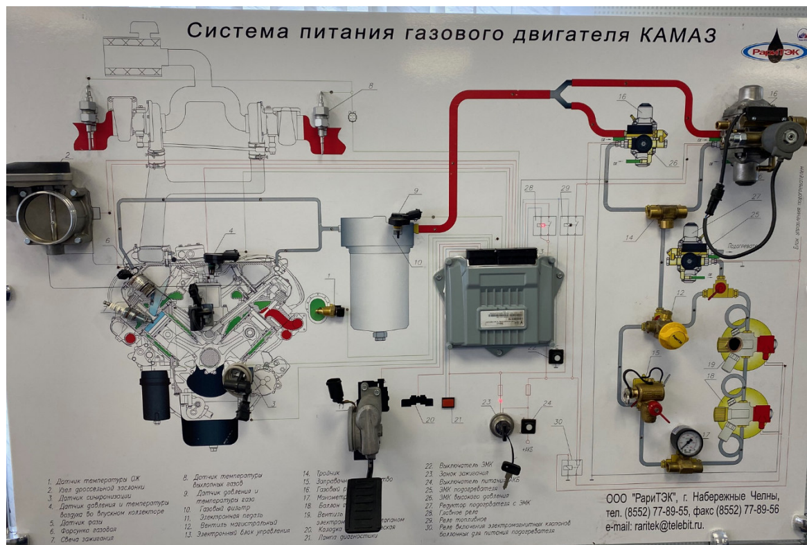
Рисунок 2 – Система питания газового двигателя КАМАЗ
