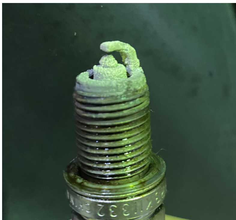
Рисунок 6 – Свеча зажигания газового двигателя КАМАЗ (золистые отложения)
