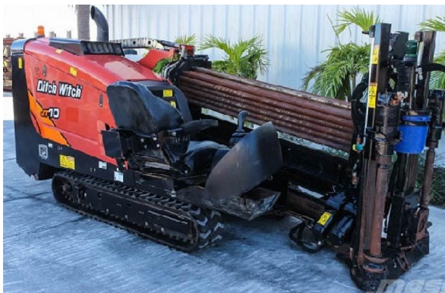
Рисунок 3 – Установка ГНБ DitchWitch JT10
