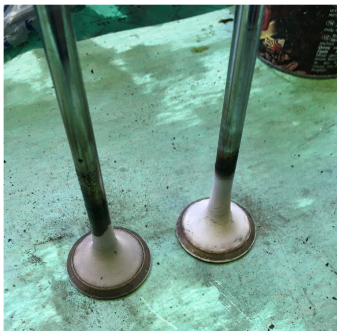
Рисунок 9 – Клапаны газораспределительного механизма двигателя КАМАЗ 820.62-300
