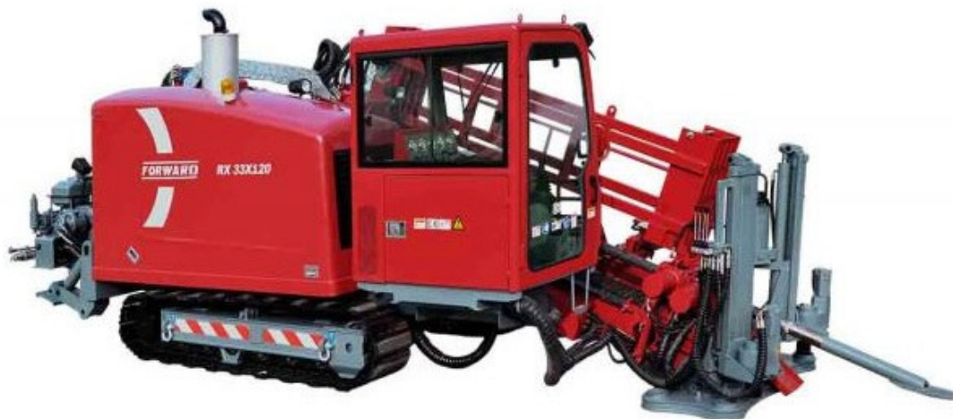
Рисунок 2 – Установка ГНБ Forward RX33x120
