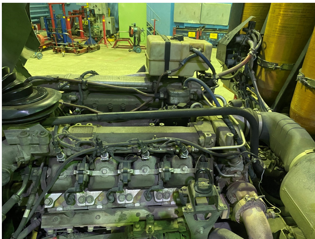
Рисунок 3 – Газовый двигатель КАМАЗ-820.62-300 с системой питания фирмы ООО «РариТЭК» (один дозатор на цилиндр за развалом)
