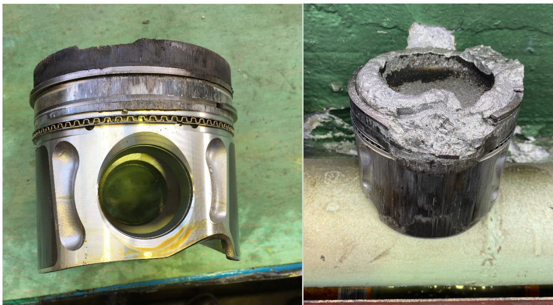
Рисунок 8 – Поршни двигателя КАМАЗ 820.62-300 при некорректной работе газовой системы питания
