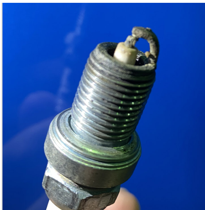
Рисунок 7 – Свеча зажигания двигателя КАМАЗ (залипшие электроды)
