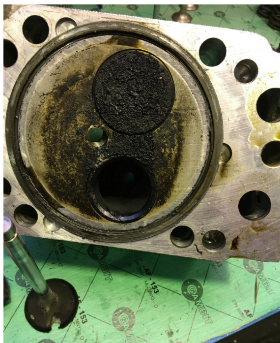
Рисунок 10 – Головка блока цилиндра газового двигателя КАМАЗ 820.62-300
