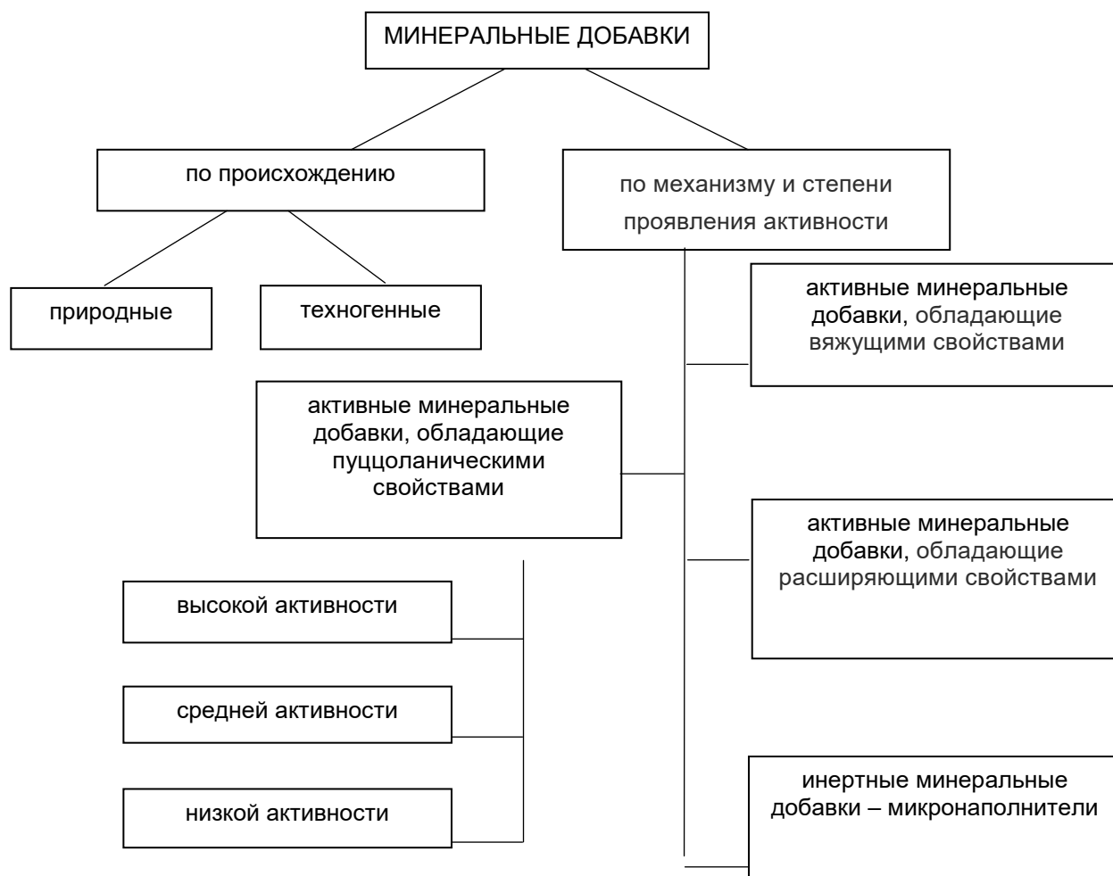
Рис. 1. Классификация минеральных добавок для бетонов и растворов
