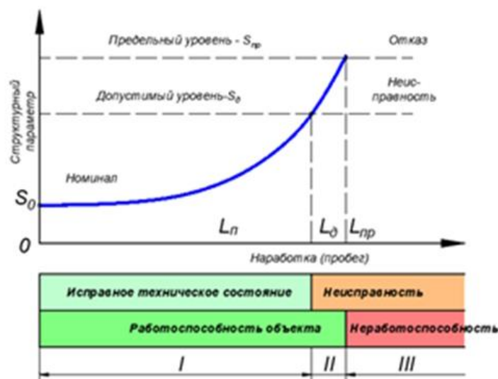
Рисунок 2 – Диаграмма к определению понятия отказа и неисправности технического состояния
