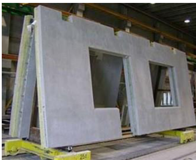
Рисунок 2 – Наружная трехслойная стеновая панель с гибкими связями
