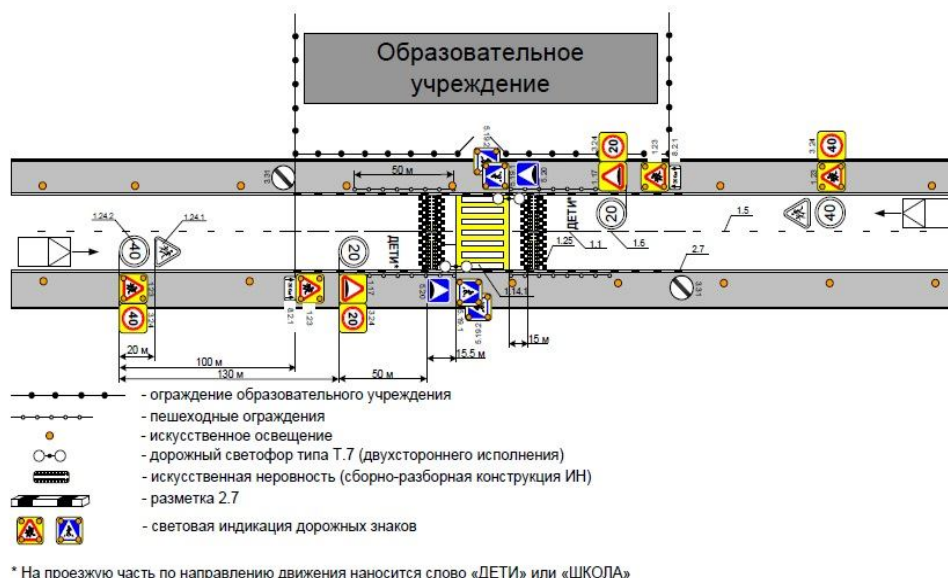
Типовая схема организации дорожного движения на нерегулируемом пешеходном переходе в непосредственной близости от образовательного учреждения при двухполосном движении транспортных средств
