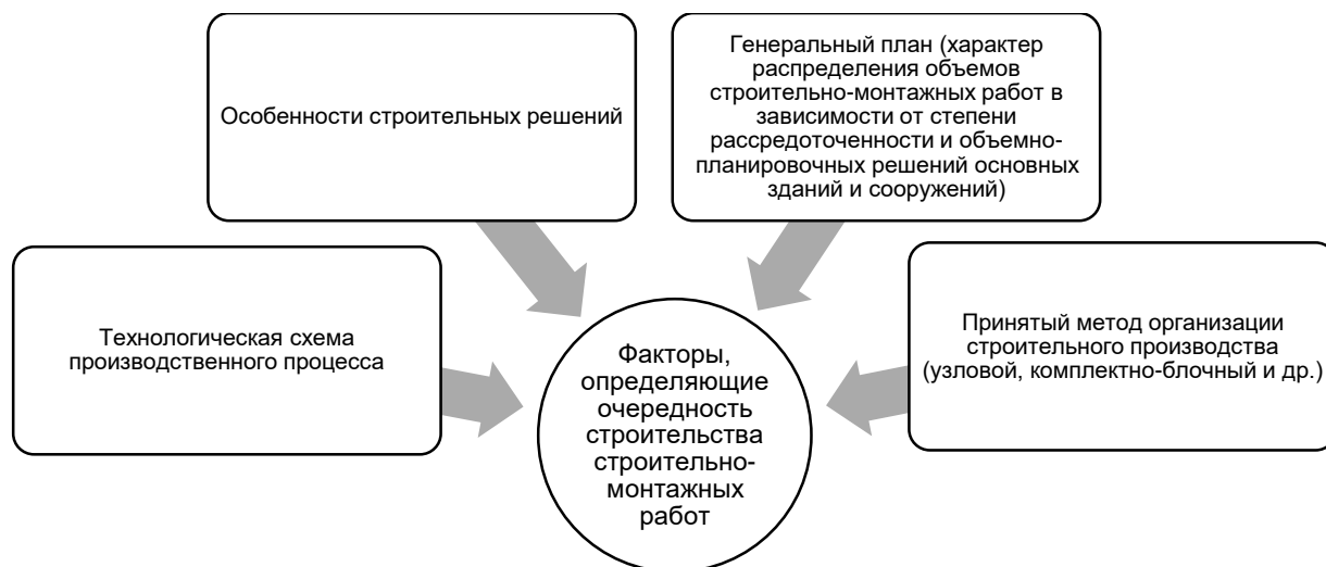
Рисунок 2 – Факторы, определяющие очередность проведения строительно-монтажных работ
