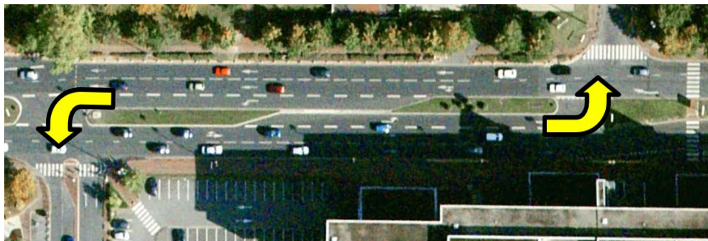
Рисунок 1 – Технологический разрыв разделительной полосы
