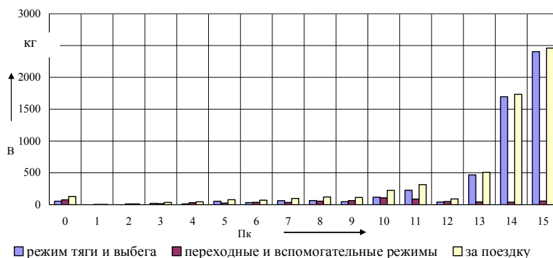
Рис. 4. Распределение расхода топлива дизелем тепловоза за поездку по позициям контроллера в нечетном направлении
