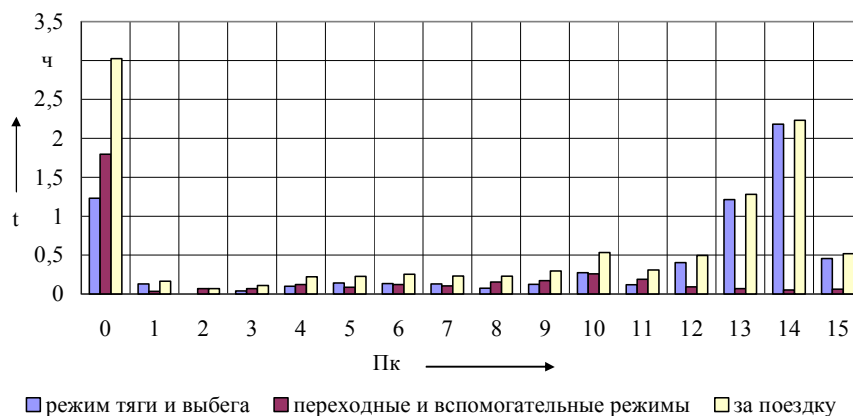
Рис. 1. Распределение времени работы по позициям контроллера в четном направлении
