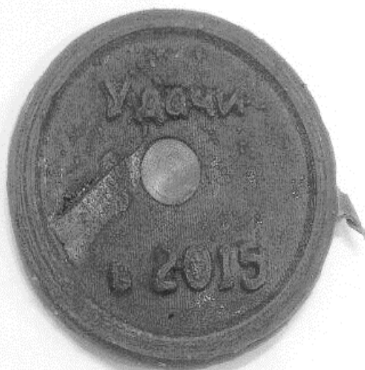
Рис. 6. Отливка изделия из полипропилена в металлополимерной матрице
