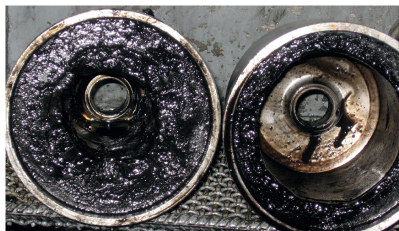
Рис. 4 Отложения на стенках центробежного фильтра очистки масла
