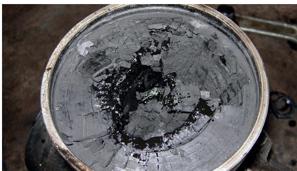
Рис. 4 Отложения на стенках центробежного фильтра очистки масла
