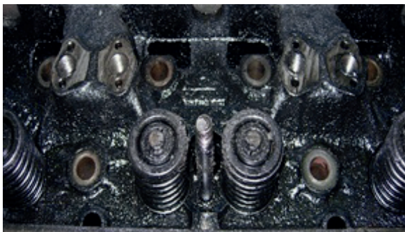
Рис. 1 Нагар и отложения на поверхностях головок блоков цилиндров и деталях газораспределительного механизма
