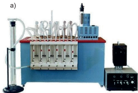
Рис.5. Аппарат для определения стабильности масел: а) общий вид; б) схема: 1 – термостатирующая баня; 2 – блок управления; 3 – блок ротаметров; 4 – моностат; 5 – прибор ВТИ; 6 – приёмная ловушка; 7 – контрольный термометр; 8 – заглушка; 9 – щуп; 10 – штатив; 11 – электронный датчик температуры; 12 – кран; 13 – терморегулятор; 14 – розетка РШАГКУ-14-1; 15 – заводская табличка.
