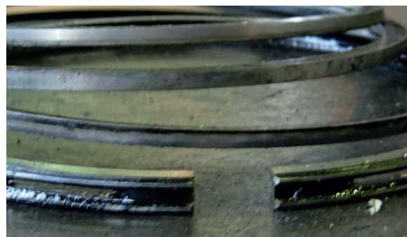
Рис. 3 Отложения на поверхностях цилиндра-поршневой группы
