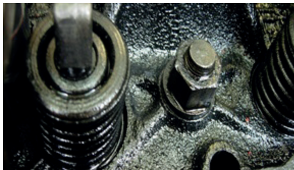
Рис. 1 Нагар и отложения на поверхностях головок блоков цилиндров и деталях газораспределительного механизма
