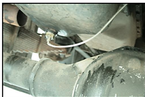
Рис. 2. Датчик температуры масла Установленный на место сливной пробки
