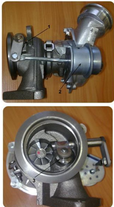
Рис. 1. Турбокомпрессор с перепускным устройством: 1 – рычаги управления заслонкой; 2 – пневматическая камера управления; 3 – заслонка
