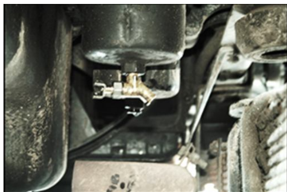
Рис. 1. Пробоотборник установленный в стакан масляного фильтра
