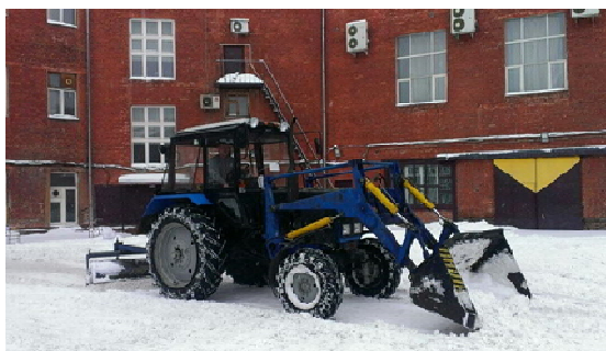
Рис. 1. Уборочно-подметальная машина на базе трактора МТЗ 80
