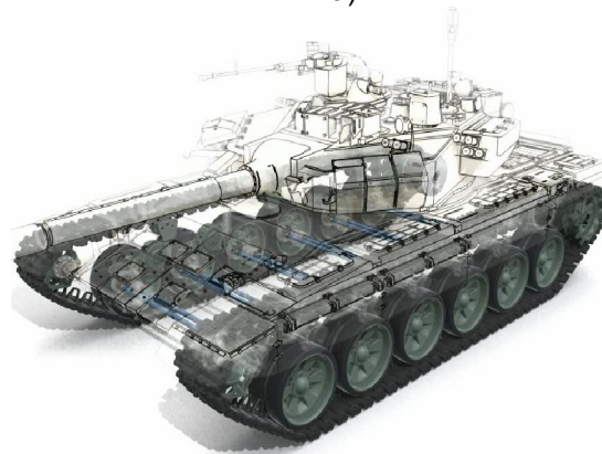
Рис. 1. Ходовая часть ВГМ (а – система поддрессоривания; б – гусеничный движитель)
