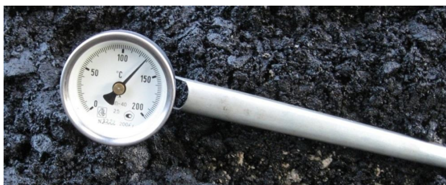
Рис. 3. Измерение температуры асфальтобетонной смеси термометром ТБП-40
