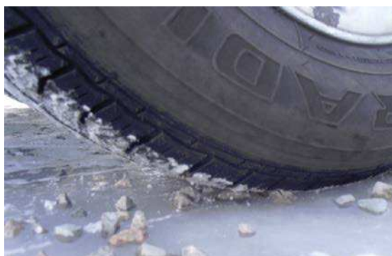
Рис. 2. Каменная шероховатость на ледяном слое дорожного покрытия
