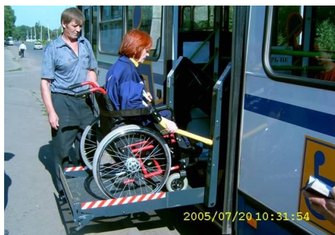
Рис. 1. Тест автобуса ЛиАЗ-5256 «Инвалидный», процесс посадки колясочника, г. Омск, июль 2005 г
