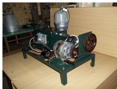
Рис. 1 Экспериментальная установка для обработки центрифуг ЯМЗ
