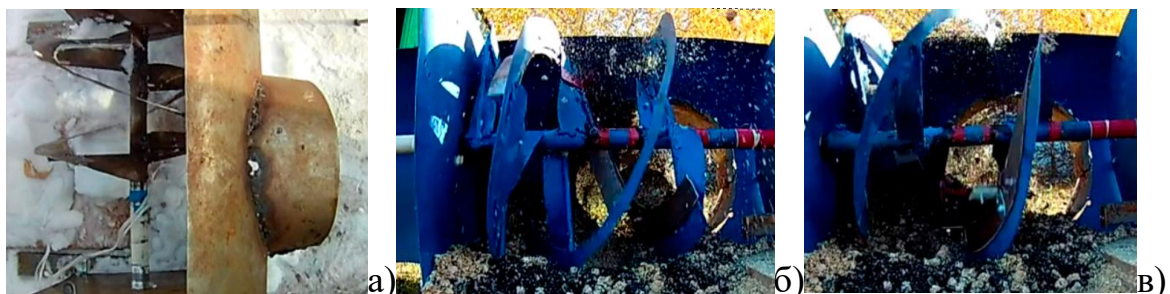
Рисунок 4.11 – Фрагмент физического эксперимента по определению значений скоростей частиц в области загрузочного окна, где а) эксперимент №1; б) эксперимент №2; в) эксперимент
