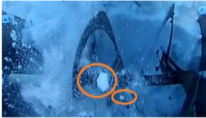
Рисунок 2.12 – Отрыв транспортируемых снежных частиц с последующим их свободным полетом при транспортировании снежной массы в питателе ФРС
