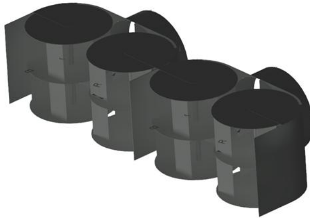
Рисунок 5.5 – Общий вид снегоочистительного оборудования с вертикальным расположением фрезерного питателя, с увеличенной шириной захвата, за счет установки дополнительных рабочих органов
