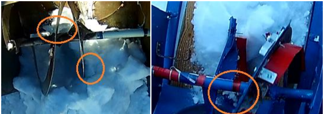
Рисунок 2.11 – Скольжение снежных частиц по поверхности отвала и ленты фрезы питателя ФРС
