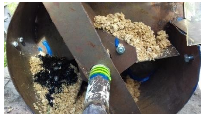
Рисунок 4.19 - Заполнение межлопастного пространства ротора МА ФРС транспортируемым материалом
