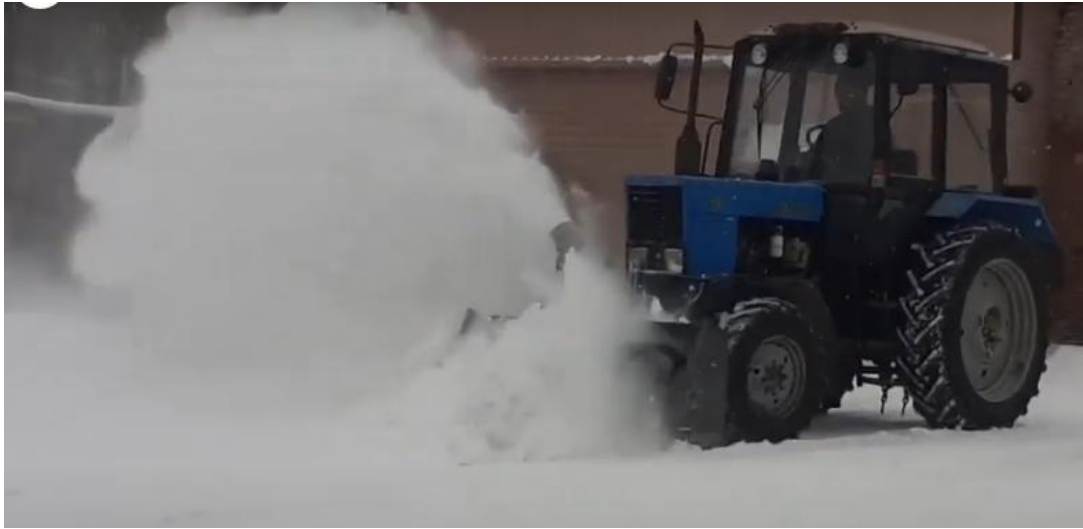
Рисунок 4.1 – Формирование снежных потоков в свободном пространстве в процессе работы ФРС.
