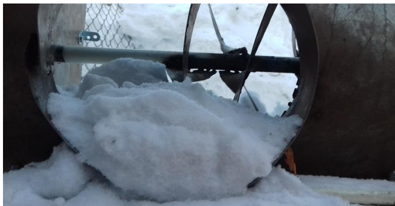
Рисунок 3.77 - Уменьшение проходного сечения загрузочного окна, обусловленное накоплением снежной массы, не захваченной лопастью ротора МА.
