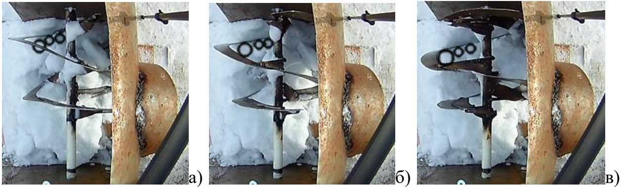
Рисунок 2.13 – Характер поступления снежных частиц в питатель ФРС: а) в начальный момент времени, t_0 ; б) через 0,042 с; в) через 0,084 с.
