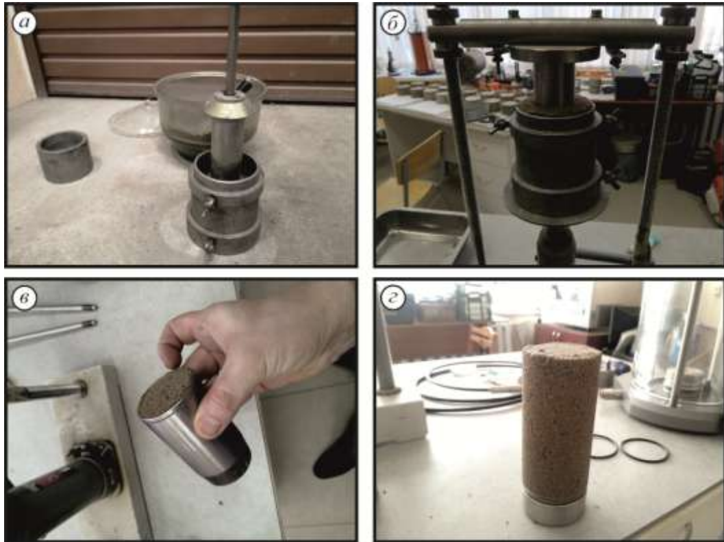
Рисунок 2.14 – Этапы изготовления образца: а – трамбование песка в ПСУ; б – отбор образца в кольцо-пробоотборник; в – образец в кольцо-пробоотборнике; г – образец, извлеченный из кольца
