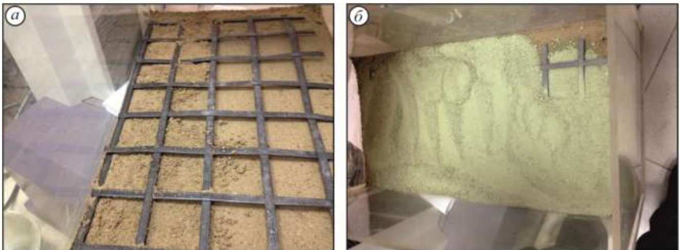
Рисунок 3.6 – Размещение армирующей решетки в модели основания: а – укладка геосинтетики на поверхность песчаного слоя; б – распределение окрашенного песка в геосинтетическом материале
