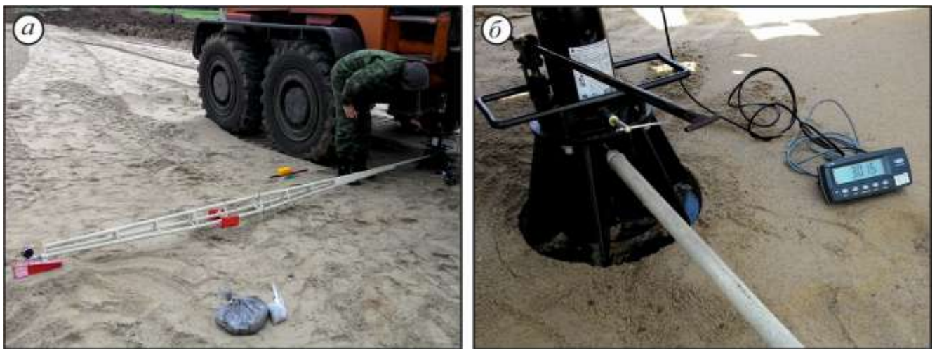
Рисунок 4.27 – Установка для штамповых испытаний: а – установка в сборе; б – размещение штампа, динамометра и измерительного щупа прогибомера в процессе выполнения эксперимента
