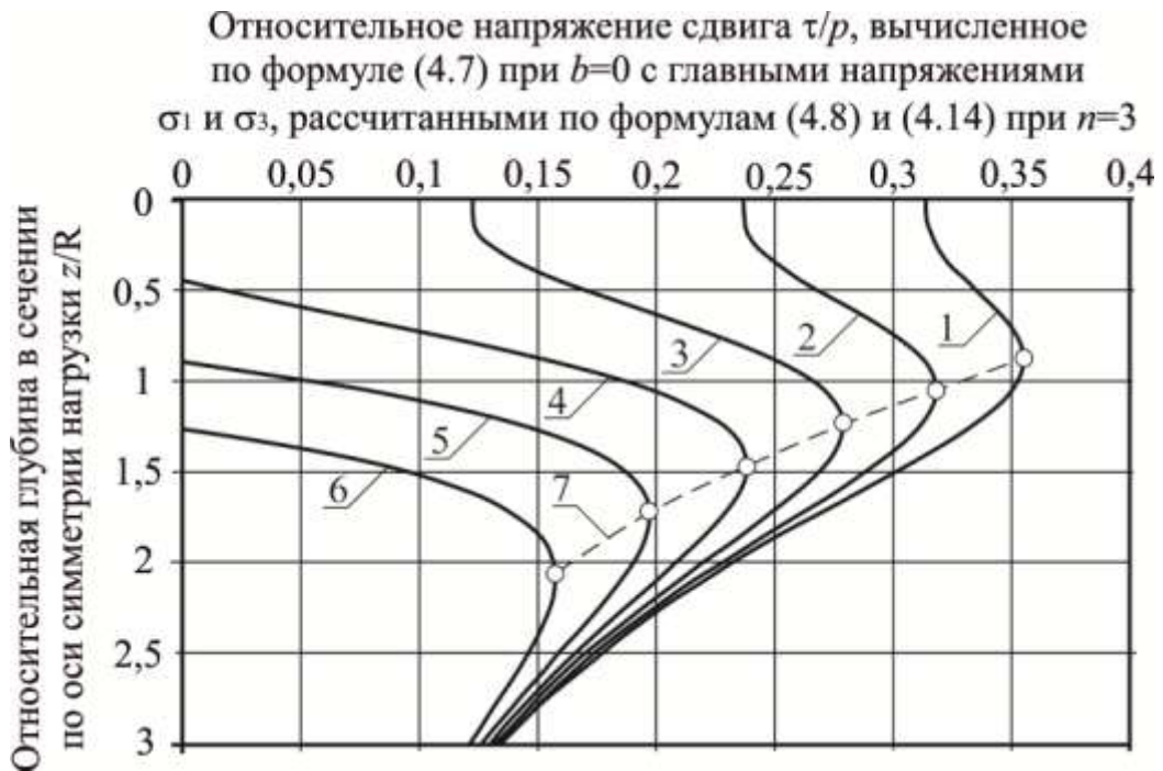
Рисунок 4.6 – Зависимость относительной величины напряжений сдвига \tau/p , рассчитанных по формуле (4.7) при b=0 и вычислении главных напряжений по формулам (4.8) и (4.14) при n=3 , от относительной глубины z/R и угла внутреннего трения \varphi : 1 – 6 – при угле внутреннего трения 0; 10; 20; 30; 40; 50; 7 – линия местоположения опасных точек
