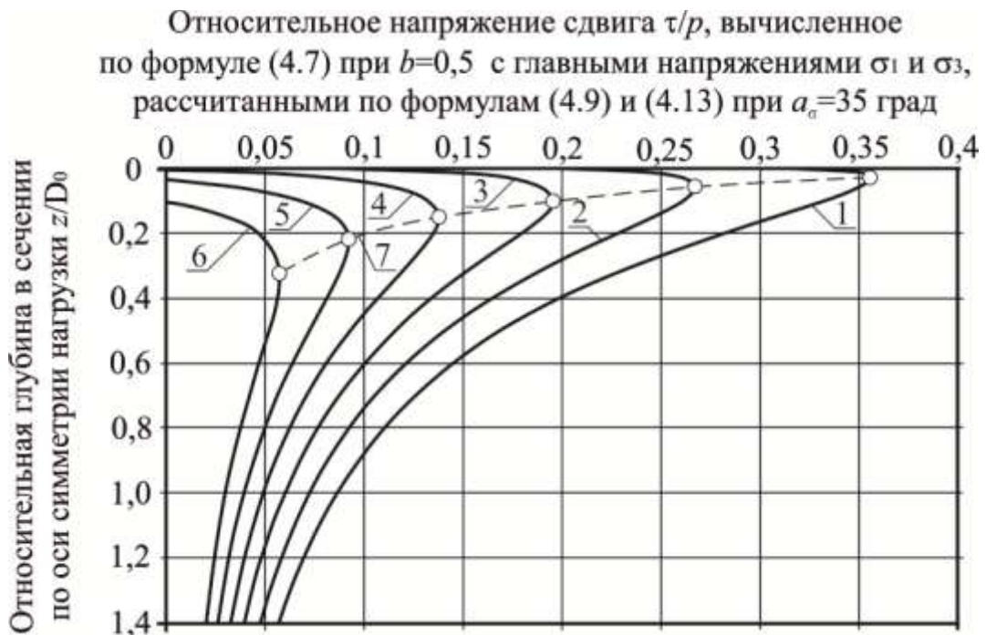
Рисунок 4.11 – Зависимость относительной величины касательных напряжений \tau/p , рассчитанных по формуле (4.7) при b=0,5 и вычислении главных напряжений по формулам (4.9) и (4.13) при \alpha_\sigma=35 , от относительной глубины z/R и угла внутреннего трения \varphi : 1 – 6 – при угле внутреннего трения 0; 10; 20; 30; 40; 50; 7 – линия местоположения опасных точек
