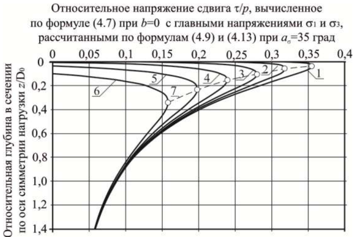
Рисунок 4.17 – Зависимость относительной величины касательных напряжений \tau/p , рассчитанных по формуле (4.7) при b=0 и вычислении главных напряжений по формулам (4.9) и (4.13) при \alpha_\sigma=35 , от относительной глубины z/R и угла внутреннего трения \varphi : 1 – 6 – при угле внутреннего трения 0; 10; 20; 30; 40; 50; 7 – линия местоположения опасных точек
