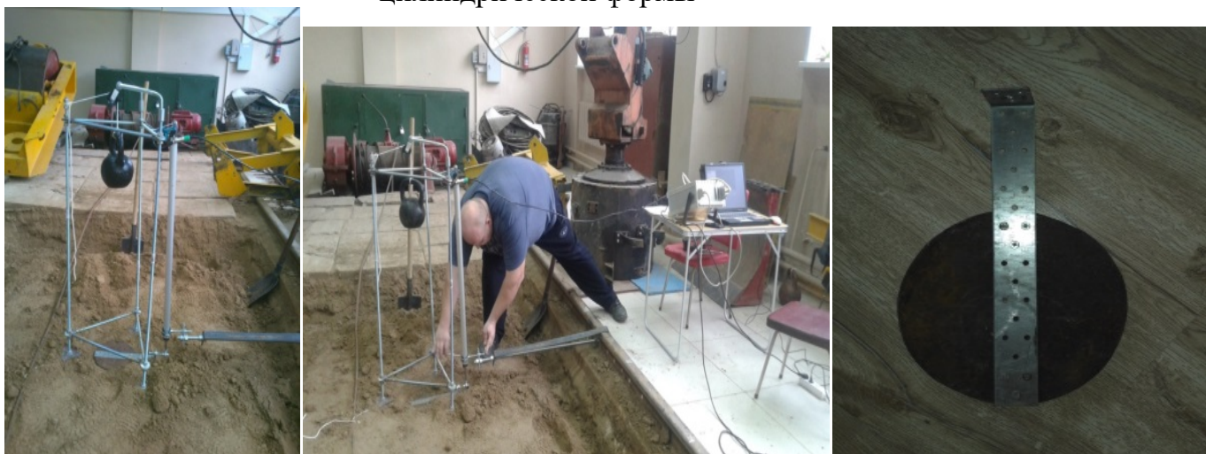
Рисунок 6 – Экспериментальная установка в грунтовом канале СибАДИ и штамп плоской формы
