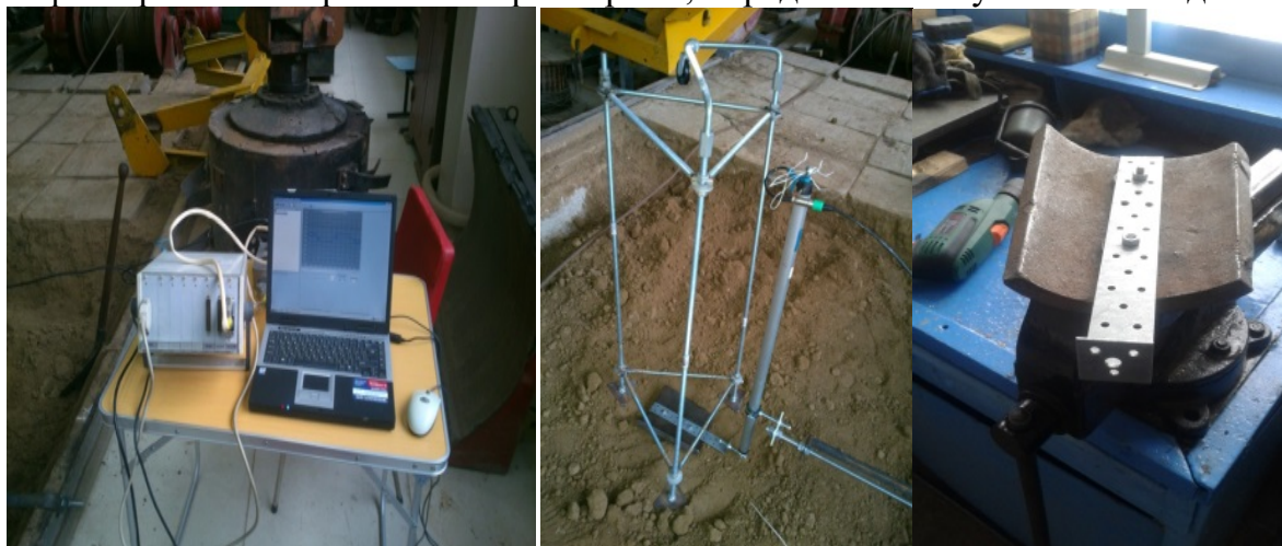
Рисунок 5 – Экспериментальная установка в грунтовом канале СибАДИ и штамп цилиндрической формы
