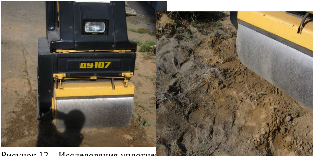
Рисунок 12 – Исследования уплотнения суглинистых грунтов катком дУ-107
