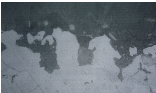
Рисунок 4.14 – Поры в ферритной кайме, х300
