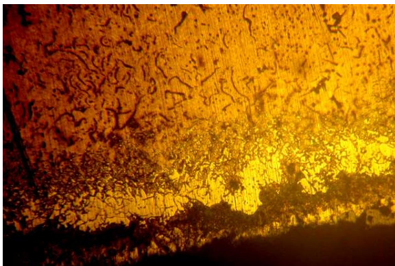
Рисунок 4.13 – Микроструктура слоя после взаимодействия с оксидом титана, x100
