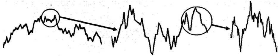
Рисунок 2.11 – Самоафинность профиля шероховатости поверхности
