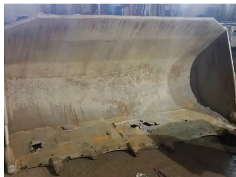
Рисунок 7.7 – Ковш минипогрузчика Termit 1000 без износостойких элементов через 2 месяца работы
