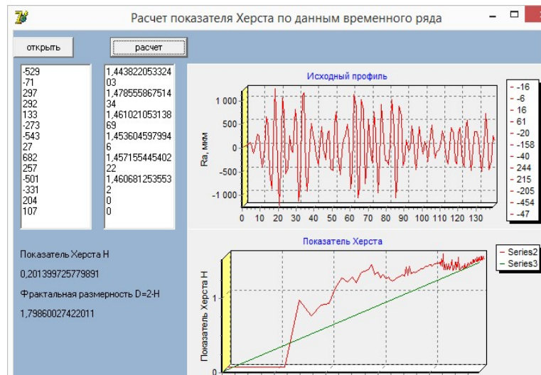
Рисунок 2.16 – Определение фрактальной размерности при помощи показателя Херста
