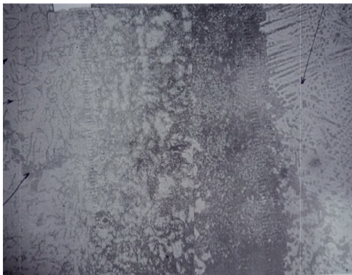
Рисунок 7.4 – Микроструктура сварного шва, x300
