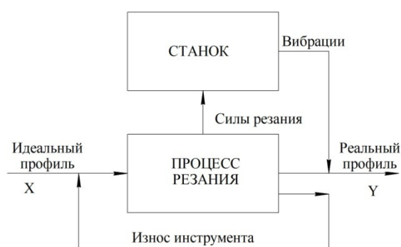
Рисунок 2.9 - Блок-схема образования микронеровностей при токарной обработке
