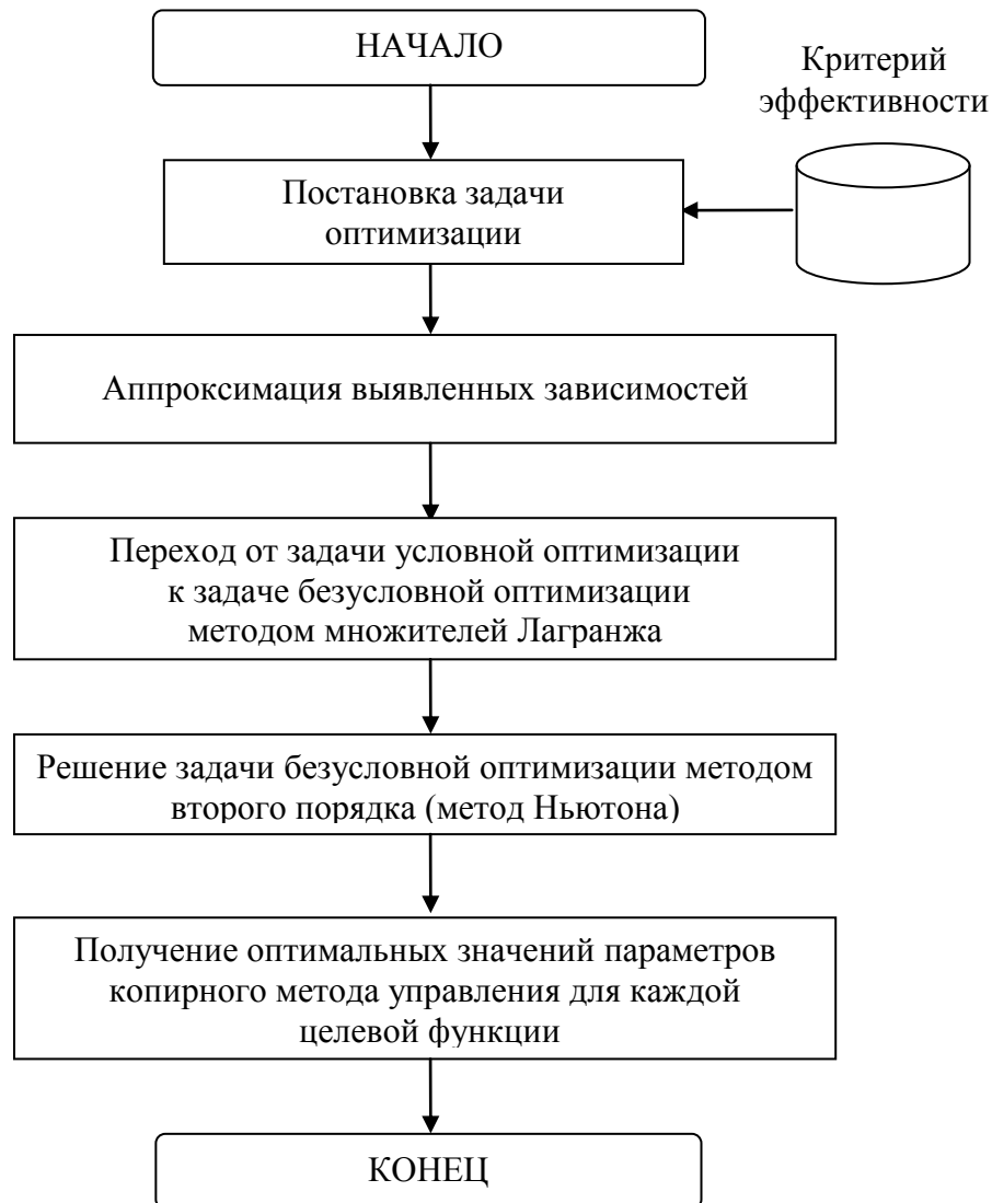
Рисунок 2.1.1 – Алгоритм оптимизационного синтеза методом Ньютона [232]
