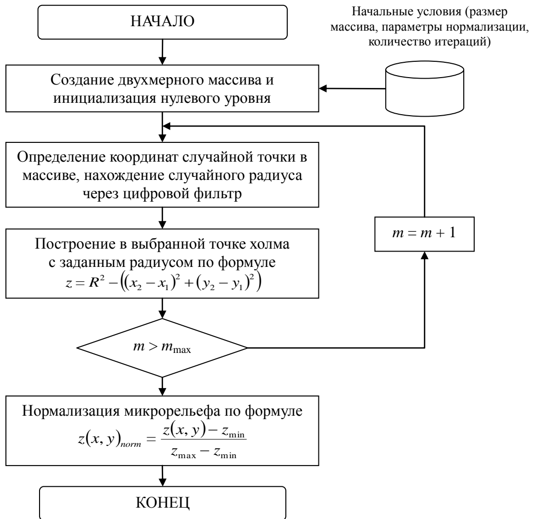
Рисунок 3.6.3 – Блок-схема алгоритма генерации трехмерного микрорельефа
