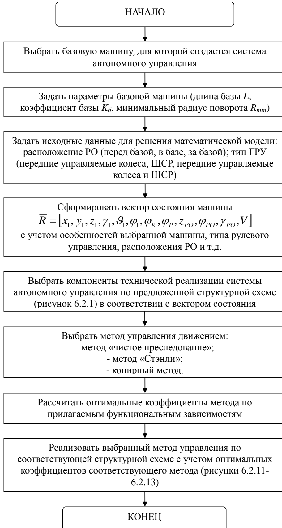
Рисунок 6.2.10 – Алгоритм инженерной методики создания системы автономного управления дорожно-строительной машины
