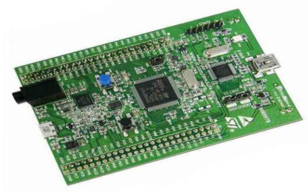
Рисунок 6.2.3 – Плата STM32F407 Discovery Kit [239]
